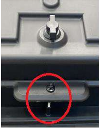
Kuva 10. Kattoluukun lukitus ja ruuvi varmistus
