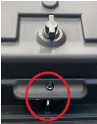
Kuva 10. Kattoluukun lukitus ja ruuvi varmistus
